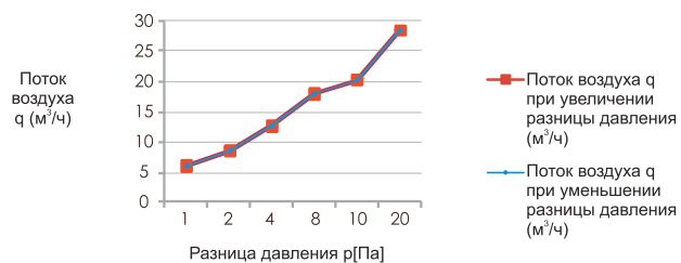
График 4. Зависимость потока воздуха q (м 3 /ч), протекающего через клапан VT 601, от разницы давления p (Па)
