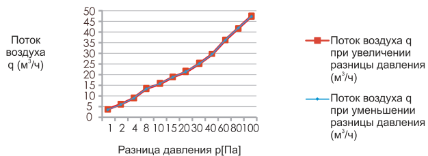
График 2. Зависимость потока воздуха q (м 3 /ч), протекающего через клапан VT 201, от разницы давления p (Па)
